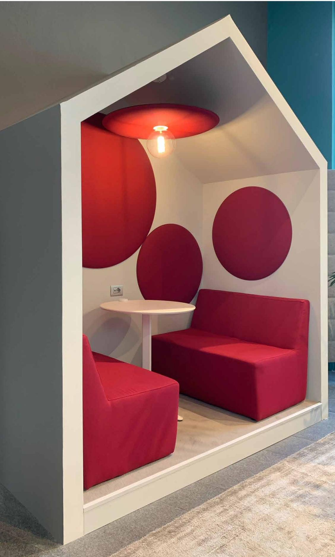
MiCasa è una casetta acustica in cartongesso di dimensioni 120x200xh170/230, completa di pedana a pavimento cablata, rivestita in moquette, illuminazione, prese elettriche e di rete, pannelli fonoassorbenti e salotto interno.
