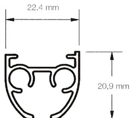
**Sistema manuale azionato a strappo per tende arricciate leggere e di peso medio .**
