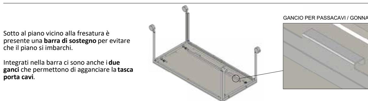
Sotto al piano vicino alla fresatura è presente una **barra di sostegno** per evitare che il piano si imbarchi.
