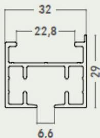
FISSAGGIO BINARIO A SOFFITTO - CEILING FIX
