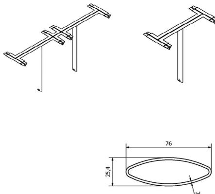
sono realizzate in tubolare metallico avente medesima sezione delle gambe perimetrali in estruso di alluminio e sono verniciate a polveri epossidiche senza metalli pesanti nei colori Bianco e Antracite. Sono opportunamente sagomate e forate per consentire l'assemblaggio alle altre componenti strutturali. Nella parte terminale sono dotate di inserto in plastica atto all'alloggiamento del piedino di regolazione. Le parti in plastica sono in tinta con quelle in metallo.
