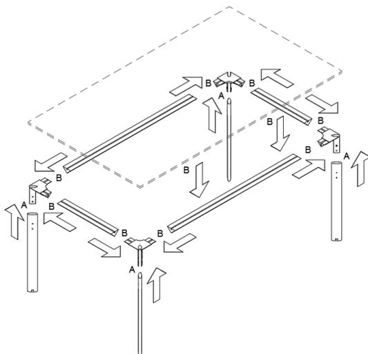
**A** = Assemblaggio con viti zincate TSPEI M6x14    **B** = Assemblaggio con viti zincate TIBEI M6X8
