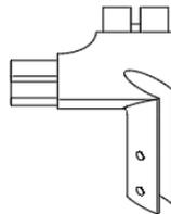
la sezione triangolare delle travi longitudinali e trasversali e quella ellittica del fusto verticale della gamba perimetrale sono raccordate e rese solidali mediante uno snodo angolare a tre vie realizzato in pressofusione di alluminio verniciato nei medesimi colori delle altre parti strutturali.
