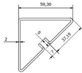
Travi perimetrali a sezione triangolare realizzate in lamiera pressopiegata spessore 20/10, opportunamente sagomate e forate per consentire l'assemblaggio alle altre componenti strutturali e/o accessorie; sono verniciate a polveri epossidiche senza metalli pesanti nei colori Bianco e Antracite.
