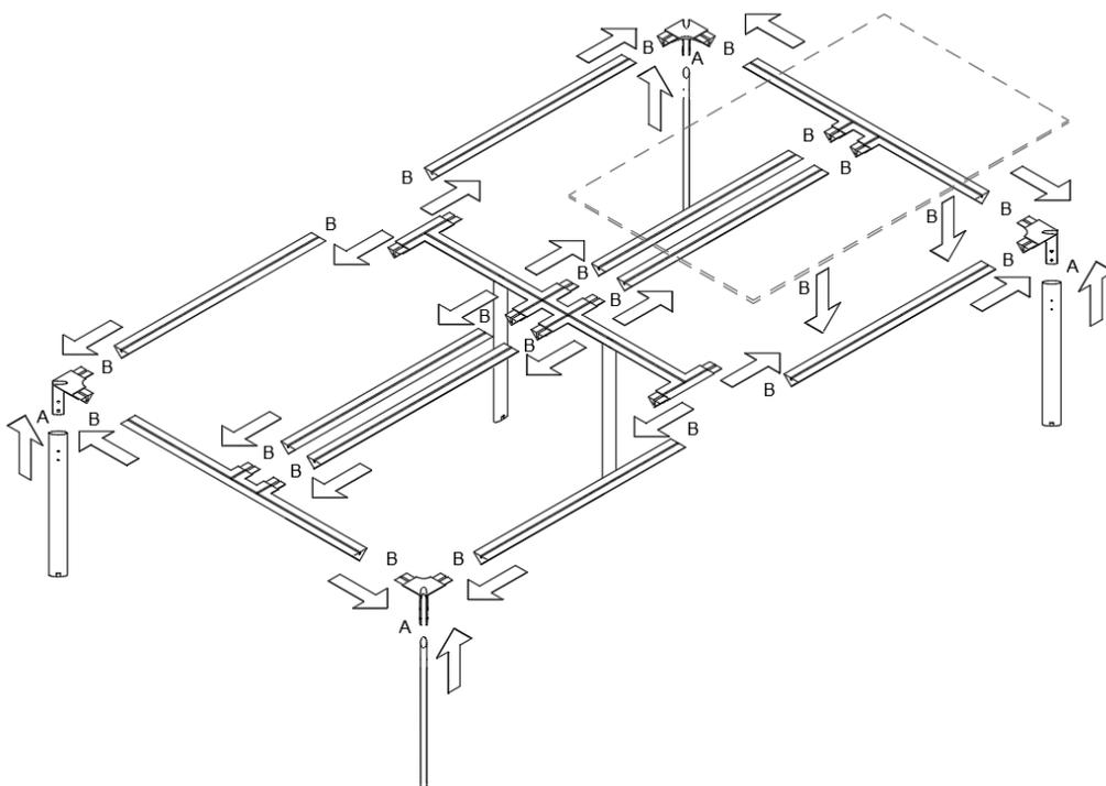
**A** = Assemblaggio con viti zincate TSPEI M6x14    **B** = Assemblaggio con viti zincate TIBEI M6X8
