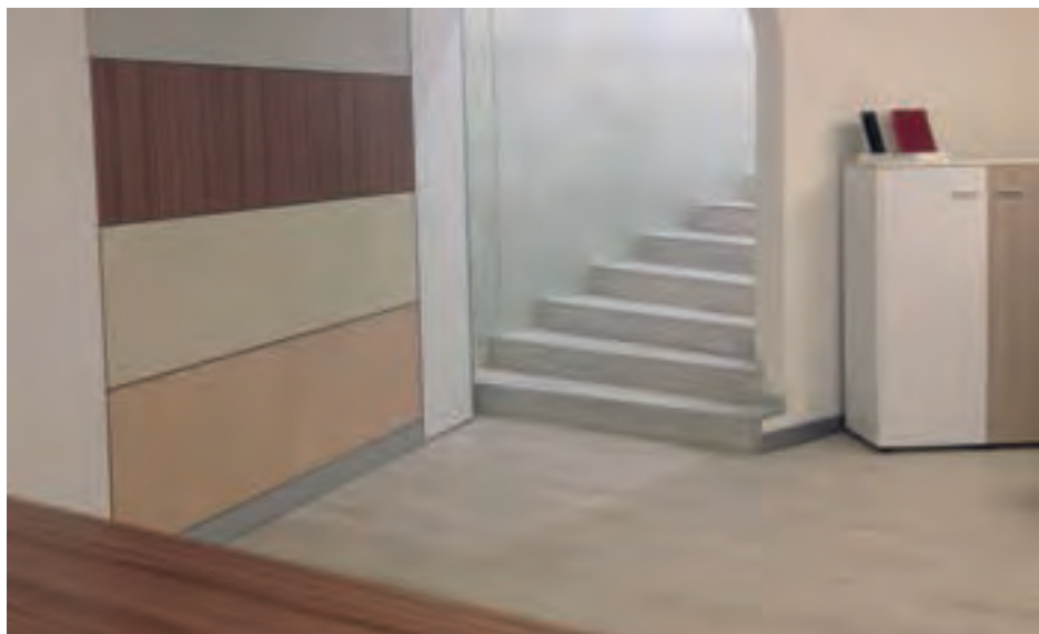
Rivestimento pavimento Evoclick rovere chiaro che si estende alle scale. La tinteggiatura della parete lungo la scala è ottenuta con vernice metallizzata.
